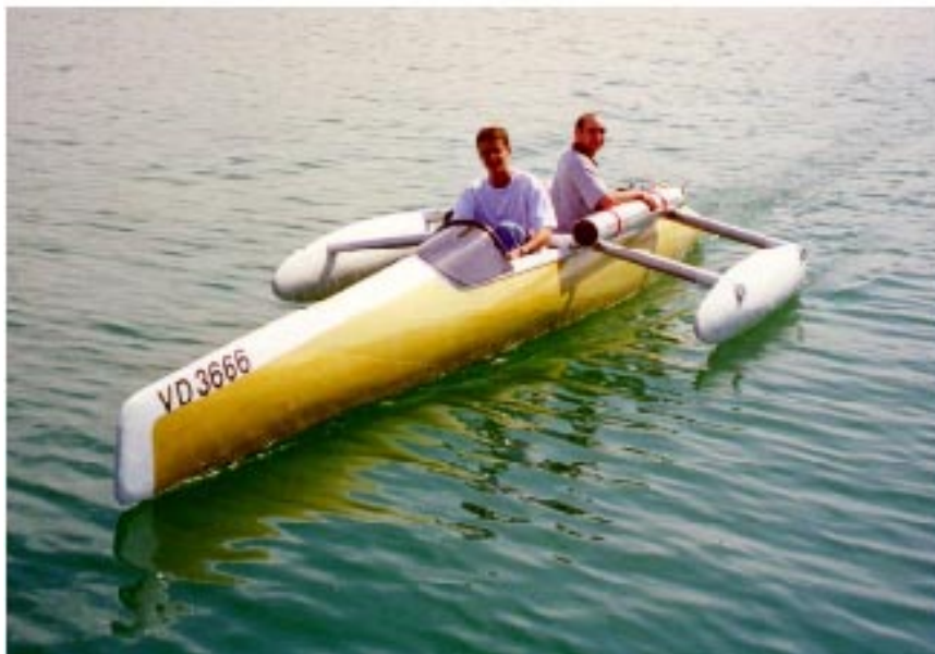
Fig 4 PEFC 300W propelled boat « Hydroxy300 »
