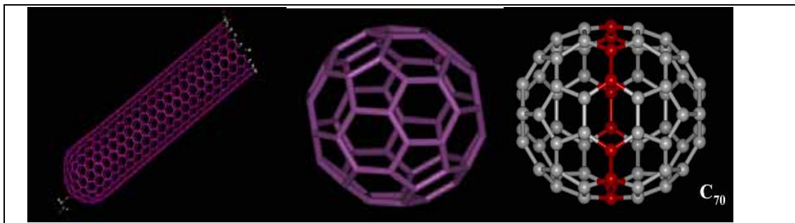
Mynd 14 Myndin sýnir gerð kolefnisgrinda (knattkol) og pípur sem gætu hentað til að geyma vetni
